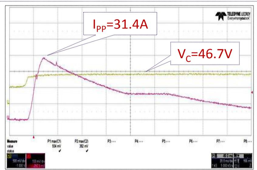
ISO16750-2 5a Test  $R_i=8\Omega$
