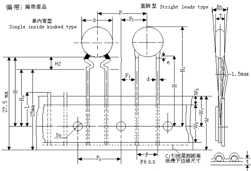
注：引脚距離和引綫形式常規按EIA和JIS的標準執行。同時我們可以根據客戶要求，做出符合客戶使用的引腳距離和引綫形式。
